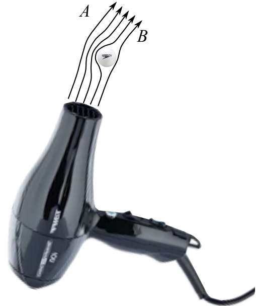
Figura 10: Bolinha de ping-pong mantida “flutuando” no ar devido ao ar soprado por um secador de cabelo.
